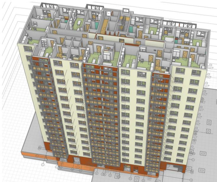
Технология информационного моделирования в строительстве. Результат - цифровой двойник здания
